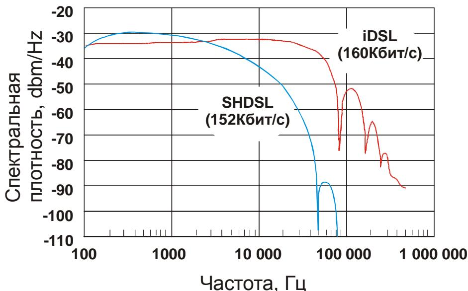
Это объясняет заведомо лучшие характеристики трансиверов SHDSL по дальностям, поскольку затухание в линиях зависит от частоты – на высоких частотах затухание сигнала больше.
